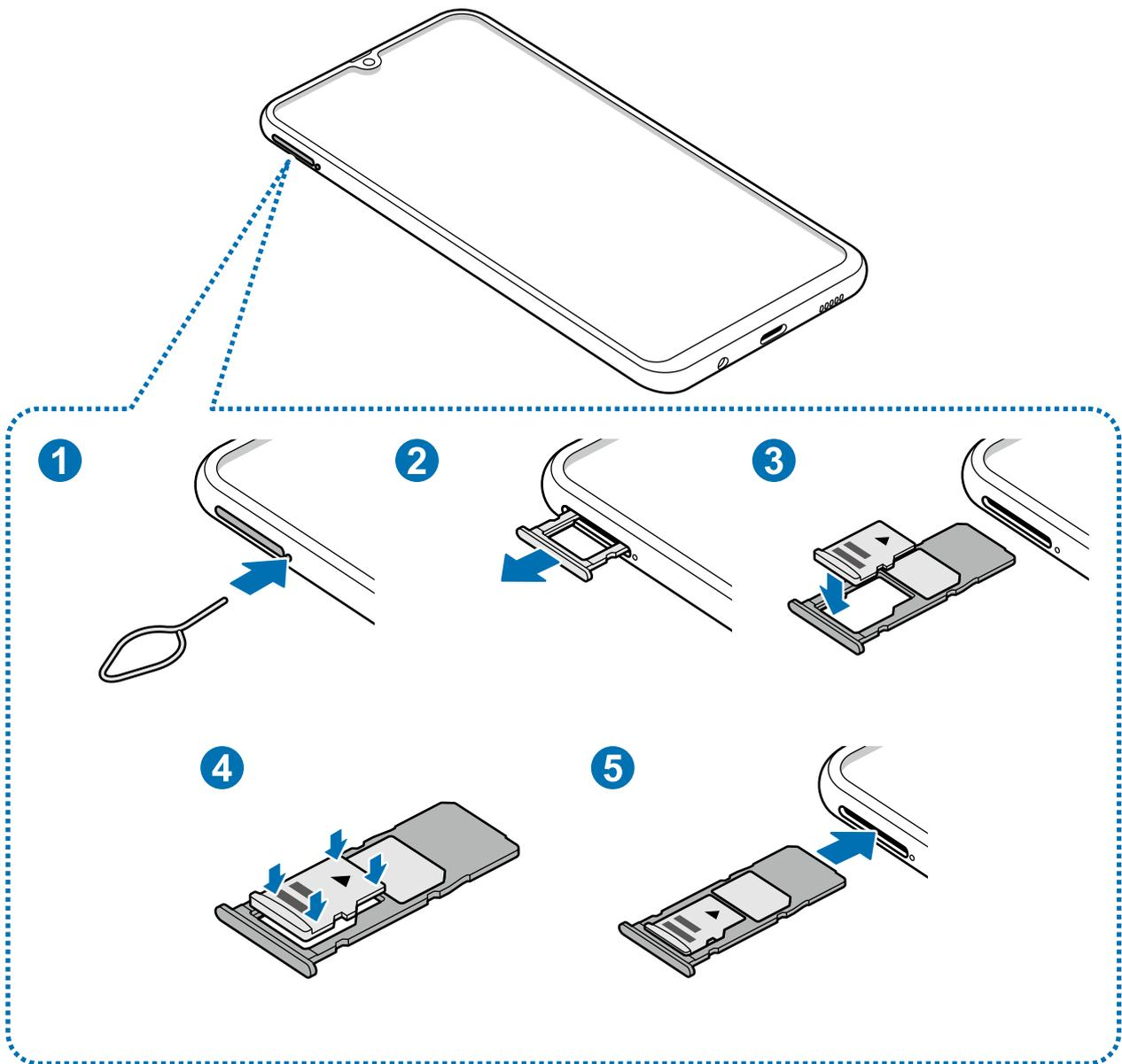
1 Insérez la broche d'éjection dans l'orifice près du plateau pour le déverrouiller.
